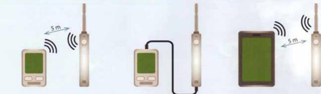
無線通信の届く範囲(5m)なら、高い場所などプローブを離しての計測が可能です。計測者と記録者がプローブと表示ユニットを各々持って計測するといった使い方もできます。ダクト点検口からプローブを挿入する際、ケーブルを引っかけて破損する心配もありません。
