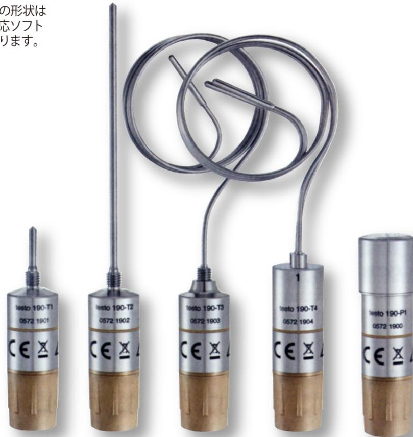
高圧蒸気滅菌・凍結乾燥プロセスの効率的な温度・圧力測定に製薬・食品・飲料業界で求められる、高圧蒸気滅菌、凍結乾燥、レトルト食品、飲料缶、缶詰の殺菌工程プロセスの温度・圧力測定に最適なロガーです。気密試験、またはオートクレーブや凍結乾燥器の圧力チェックに最適です。
